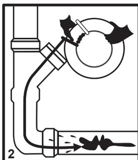
2. Introducir la cinta hasta que llegue a la obstrucción. Usar un movimiento de atrás para adelante hasta que se haya desatascado la obstrucción.
