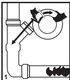
1. Sujetar el mango firmemente y girar el estuche en el sentido de las manecillas del reloj.
