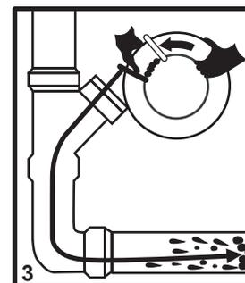
3. Retroceda la cinta sujetando el mango firmemente y girando el estuche en sentido contrario de las manecillas del reloj. Enjuagar la cañería con agua limpia.
