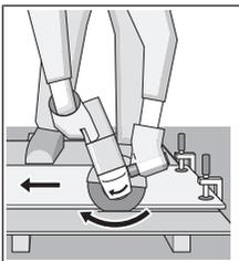
Conduzca la herramienta eléctrica siempre con un movimiento en sentido contrario. Si no, existe peligro que la herramienta salga **incontroladamente** del corte. Al tronzar perfiles y tubos de sección cuadrada, lo mejor es utilizar la sección transversal más pequeña.
