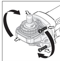
Puede girar la cabeza del engranaje en pasos de  $90^\circ$ . De este modo, el interruptor de conexión/desconexión puede situarse en una posición de manejo más adecuada para casos especiales, por ejemplo, para zurdos.
