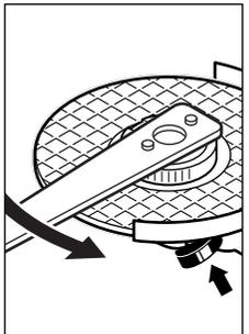
Una tuerca de fijación rápida en buenas condiciones y correctamente fijada, la puede soltar girando el tornillo moleteado con la mano en contra del sentido de giro de las agujas del reloj. **No suelte nunca una tuerca de fijación rápida inmovilizada con unas tenazas, sino utilice la llave combinada.** Aplique la llave universal como se muestra en
