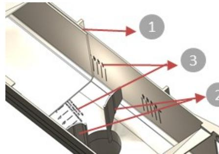
1. No se requiere pegamento para unir con las canoas con las uniones bajantes con escala de dilatación, con el nuevo
